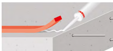
Fig. 1 Fixation avec l'adhésif Silikal Flexcol
